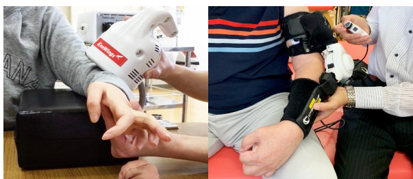
写真2 反復末梢神経磁気刺激装置（パスリーダー®）（左図） ロボットスーツHAL®（単関節型）（右図）
