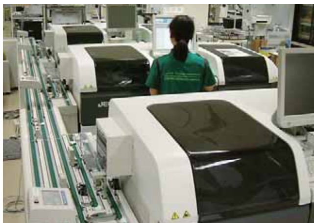
検体自動搬送システムと分析装置
