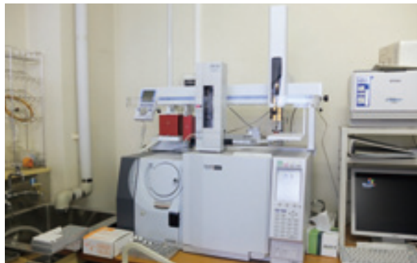
タンデムマス・スクリーニング検査を支える機器。上がタンデムマス型質量分析計(タンデム・マススペクトロメーター)で血液中のアミノ酸などを高感度で分析します。下はGC/MSと呼ばれる機器で、必要に応じて尿中有機酸分析によって診断支援をします
