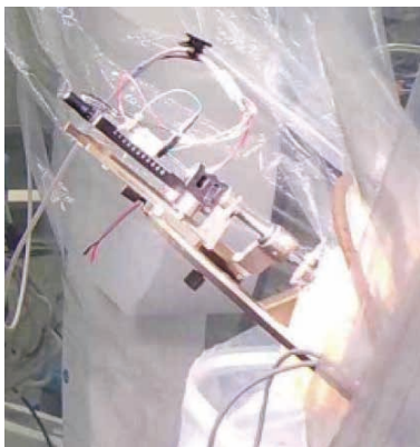
写真3:微小電極挿入用のドライバー装置
